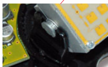
Radar module horizontaal en verticaal verstelbaar
